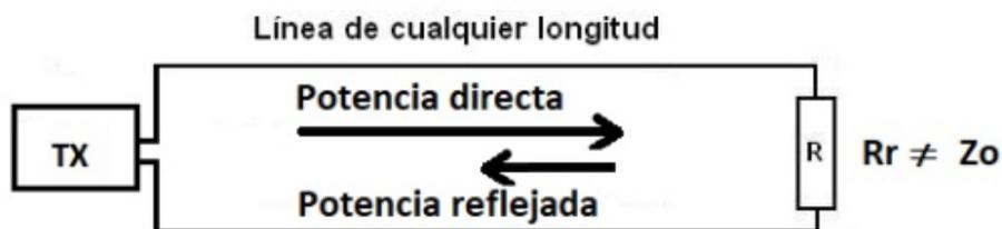
Figura 3: Línea mal adaptada produce potencia reflejada devuelta al TX.
